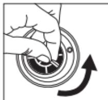
Pentru a înlocui filtrul, desurubați capacul de pe sticlă, rotiți filtrul în sens opus acelor de ceasornic și scoateți-l, trăgându-l în sus.
