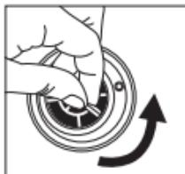
Při výměně filtru odstraňte uzávěr láhve, otočte filtr proti směru hodinových ručiček a vytáhněte jej vytažením směrem nahoru.
