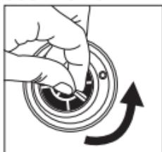
Per la sostituzione del filtro togliere il tappo della bottiglia, ruotare il filtro in senso antiorario e rimuoverlo tirandolo verso l'alto. Sostituirlo con uno nuovo ripetendo le operazioni come da paragrafi "PREPARAZIONE DEL FILTRO FAST DISK™".
