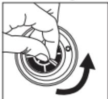
Para a substituição do filtro, retire a tampa da garrafa, rode o filtro em sentido anti-horário e remova-o puxando-o para cima.
