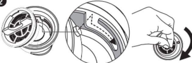
Inserire il filtro nell'apposito alloggiamento nel tappo premendo leggermente e ruotandolo in senso orario.
