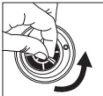
Pour remplacer le filtre, retirer le bouchon de la bouteille, tourner le filtre vers la gauche et l'extraire en le tirant vers le haut.
