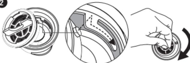
Zasuňte filtr do speciálního uložení v uzávěru lehkým zatlačením a otočením ve směru hodinových ručiček.
