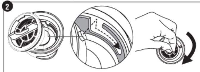
Setzen Sie den Filter durch leichtes Drücken in die entsprechende Position am Deckel ein und drehen Sie ihn im Uhrzeigersinn.
